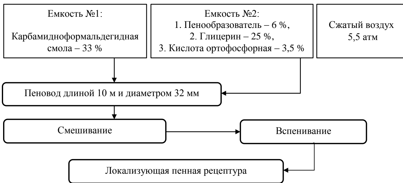
Рисунок 1 – Схема получения пены для локализации АХОВ
